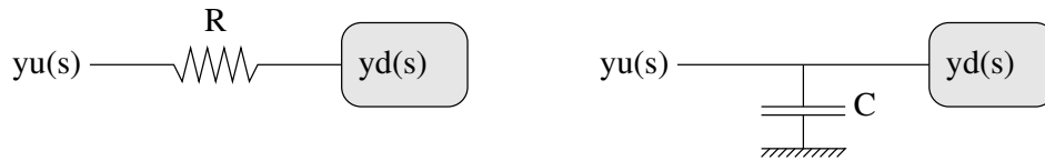
FIG. 4.2 – Les deux admittances possibles dans le cas des arbres RC
